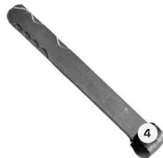
La clé physique 4 permet de démarrer le scooter sans la télécommande et s'extrait de la télécommande via le switch 5
